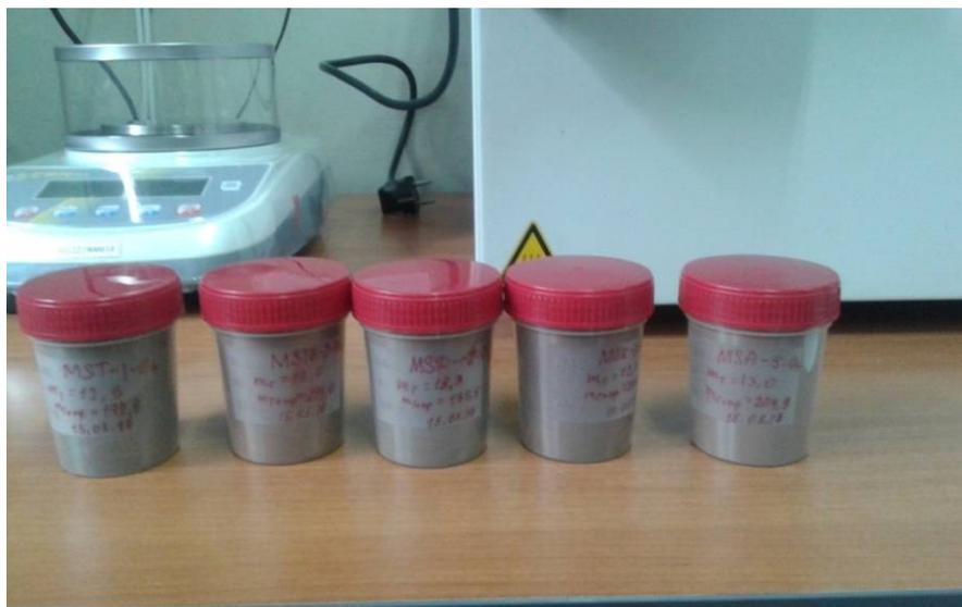
Рис 4. Упакованные пробы почв для измерения гамма-спектрометрии
