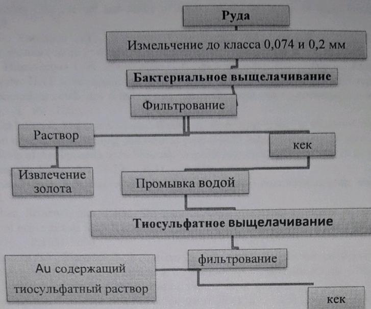
Рисунок 6 – Схема двухстадийного биохимического выщелачивания золота из руды месторождения Большевик
