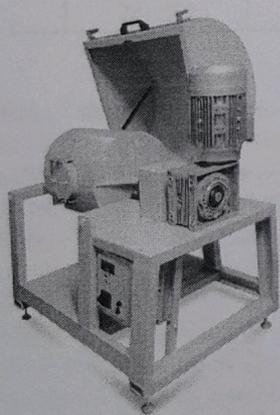
Рисунок 2 – Лабораторная шаровая мельница серии VBM
