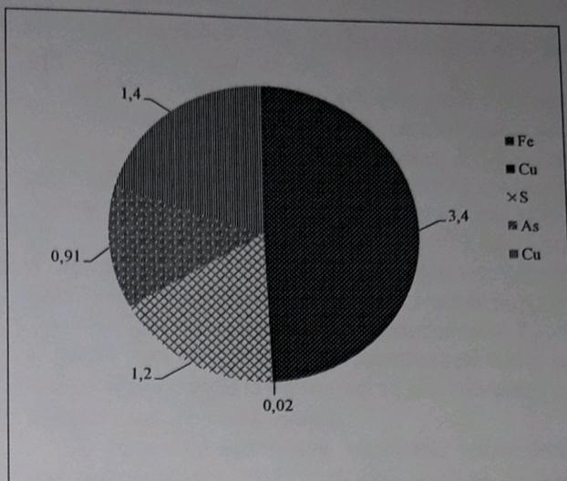
Рисунок 5 – Химический состав золотосодержащей руды месторождения Большевик
