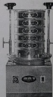
Рисунок 3 – Лабораторный классификатор размера гранул измельченной руды
