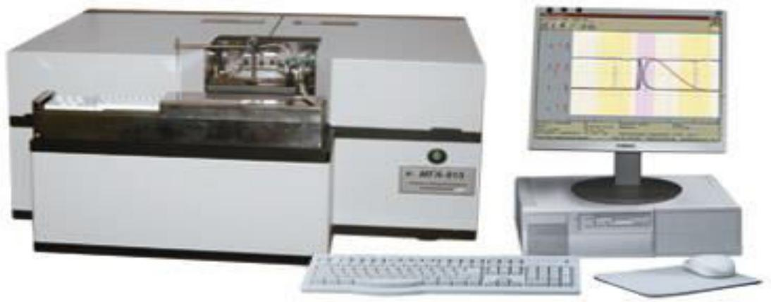
Рис.2.1. Общий вид спектрометра МГА-915
