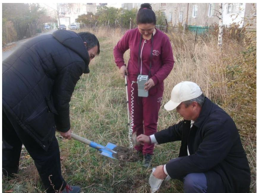
Рис. 3.39. Измерение радиационного фона и отбор проб почвы в микрорайоне «Кашка-Суу»
